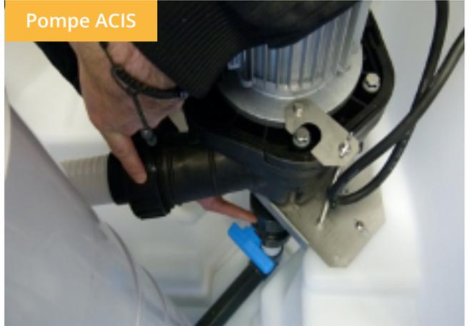
**5** Dévisser les 2 vis de fixation de la platine à chaque extrémité
