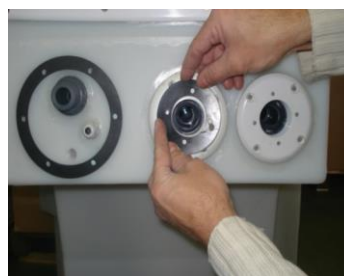
3 Collez un joint de bride sur la buse d'aspiration et la buse de refoulement
