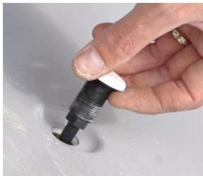
**2** Sous la coque, réalisez un joint silicone puis vissez l'écrou
